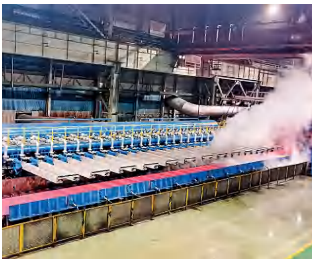
南钢 3500 炉卷轧机超密 SUPIC 快冷装置
