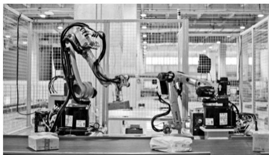
品6万箱。在货物入库、打包等环节,配备3种不同型号的六轴机械臂,应用在入库装箱、拣货、混合码垛、分拣机器人供包4个场景下;在分拣场内,引进3种不同型号的智能搬运机器人执行任务。实现入库、存储、包装、分拣的全流程、全系统的智能化和无人化,在智慧物流领域居全球领先水平,是全球首个落成并规模化投入使用的全流程无人物流中心。
